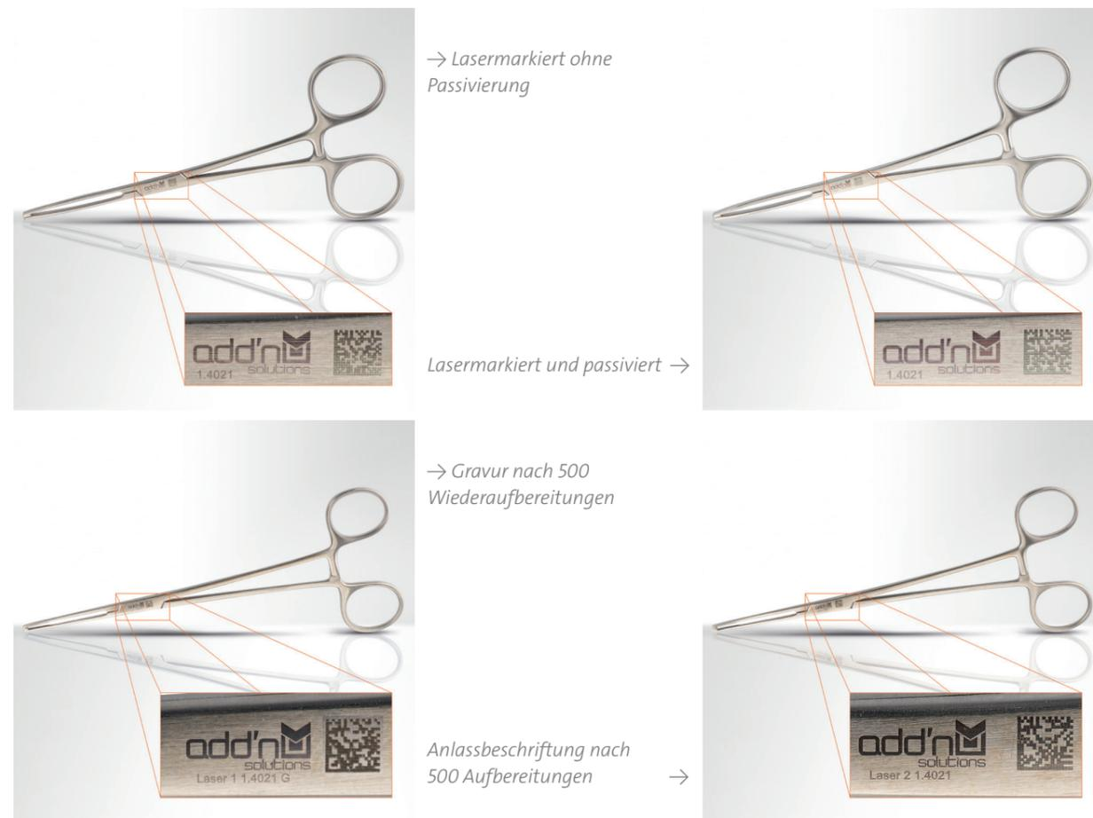
Die Validierungsstücke wurden 500fach gereinigt und autoklaviert. Die Markierung ist noch immer hervorragend lesbar. Auch nach weiteren Sterilisationszyklen wird sich daran höchstwahrscheinlich nichts mehr ändern. Nur das Instrument selbst weist die üblichen Benutzungsspuren auf.
